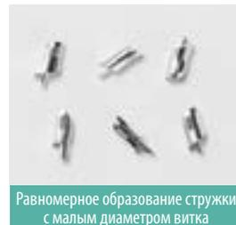
Равномерное образование стружки с малым диаметром витка
