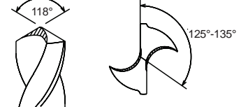
Web Thinned Point Pointe en réseau affiné Spitze mit Kegelmantelschliff Punta con alma esmerilada Вершина с подточкой перемычки
