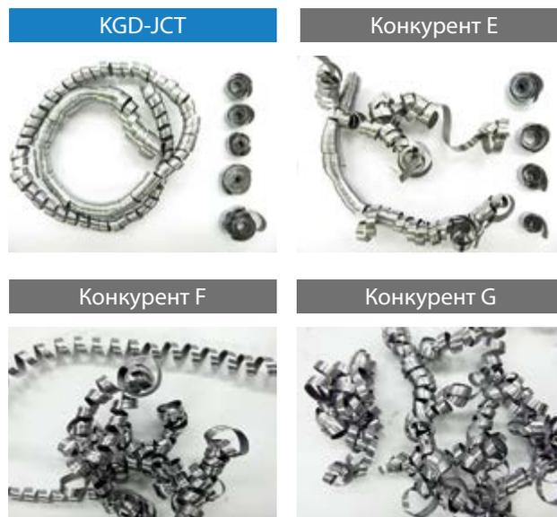
Режимы резания: Врез = 150 м/мин,  $f = 0,05$  мм/об,  $d = 8$  мм, СОЖ, ширина кромки 4 мм, заготовка: 15CrMo4, обработка канавок
