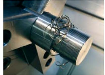
**KTN-JCT предотвращает запыливание стружки, направляя ее вниз**
