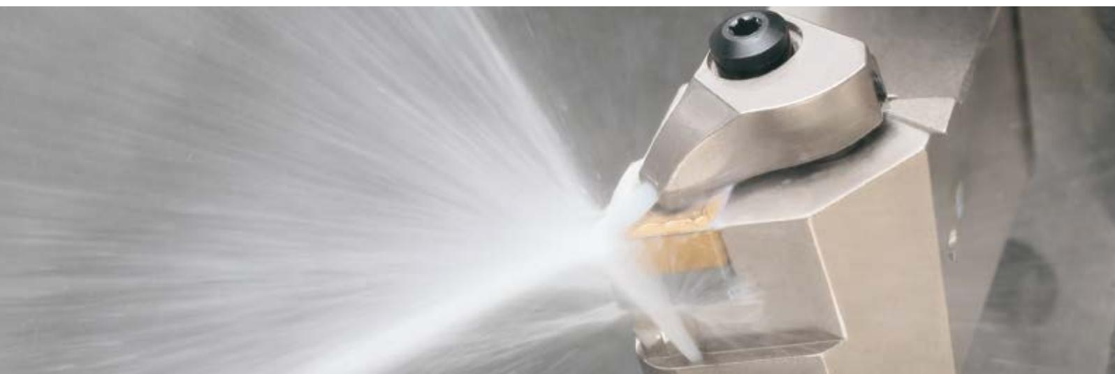
**Превосходный контроль стружки и высокая стойкость инструмента благодаря подаче СОЖ под высоким давлением**
